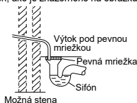
Znázornenie vedenia odtokovej hadice von
